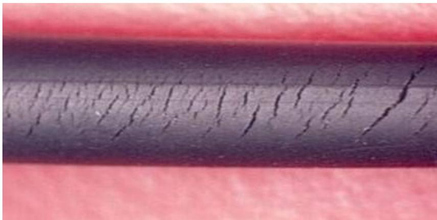
密封圈已经出现裂纹
