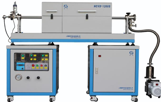
我公司生产的专业二硫化钼 CVD 系统, 内置低温热电偶, 自带硫粉加热功能!
